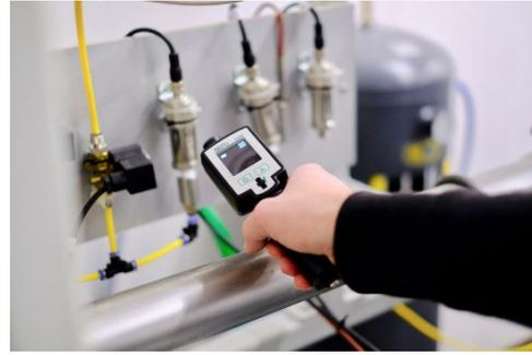
S530 超声波泄漏检测仪
